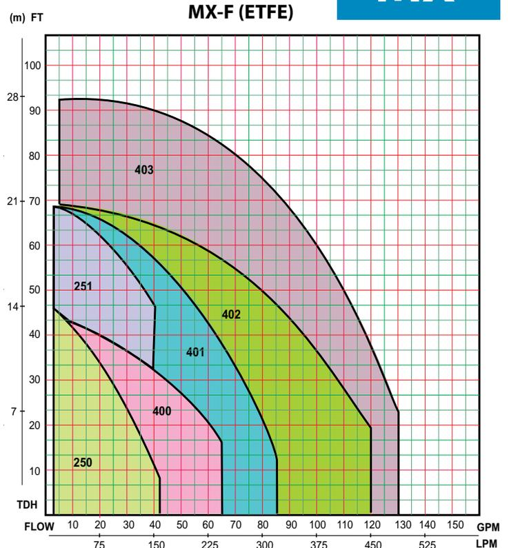
Rendimiento basado en agua @ 70F (21C). Fluidos con peso específico mayor que 1 deben ser revisados por la fabrica.
