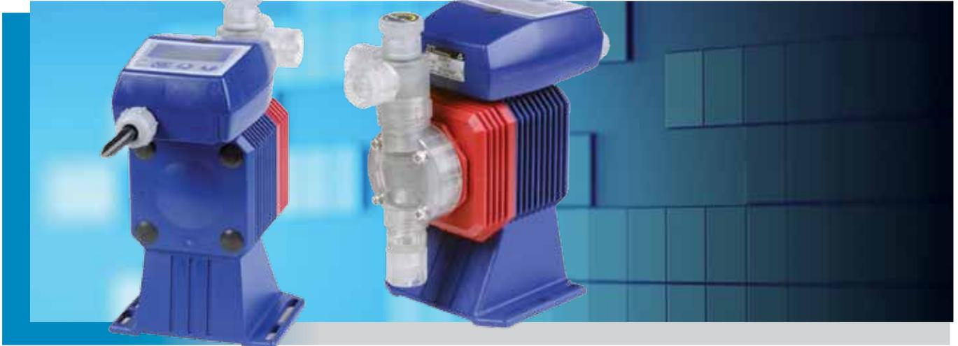
La serie de bombas dosificadoras electromagnéticas EZ con control de microprocesador ofrece una precisa inyección de productos químicos a un bajo costo. EZ ofrece capacidades hasta 400 MI/Min (6,3 GPH) y una presión máxima de 10 bar (150 PSI). Es simple de operar a través de su teclado de tres botones. La tecnología de 360 impulsos por minuto de la clase E, ofrece una versatilidad inigualable.
